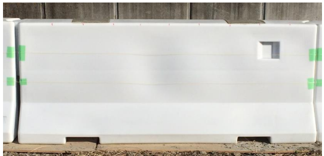
事例② 1層目の打設量が多かった場合（所定の支保工）
