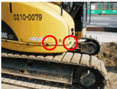
フレキシブルセンサーを付けたバックホーが作業員に接近すると作業員には「音と振動」で注意を促しオペレーターには「警報音」で危険を知らせます。周囲のコーンやガードレール等には反応しないので夜間の工事に使用しても無駄な警報音を出しません。運転席から死角となる右前方部もセンサーが監視します。本装置は、専用の充電電池で動作するので面倒な配線作業がなく現場で短時間に使用できます。
